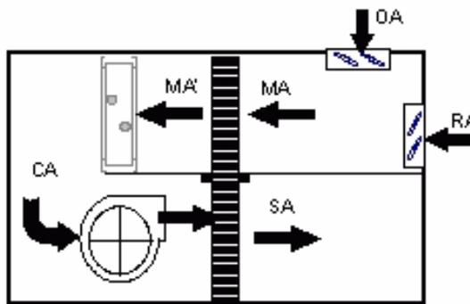
**Draw-Thru/Blow-Thru Wheel, Draw-Thru Coil**
