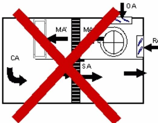
**Blow-Thru Wheel, Blow-Thru Coil**
