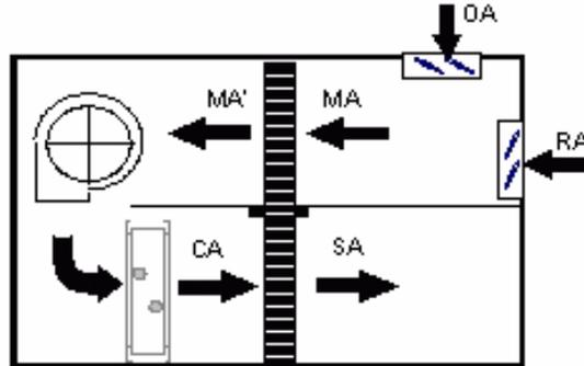
**Draw-Thru/Blow-Thru Wheel, Blow-Thru Coil**
